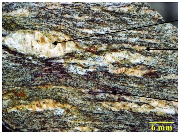
Observation à l'œil nu d'un échantillon de gneiss montrant une orientation des minéraux
