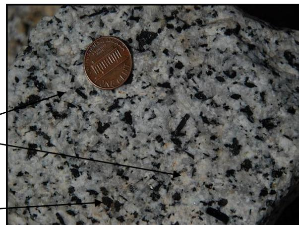
Observation à l'œil nu d'un échantillon de granite montrant l'absence d'orientation des minéraux
